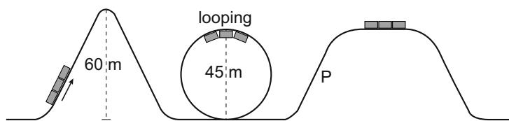
Met een ketting worden drie gekoppelde wagentjes langs de eerste helling naar het hoogste punt van de baan getrokken. Daarna worden ze losgelaten.
